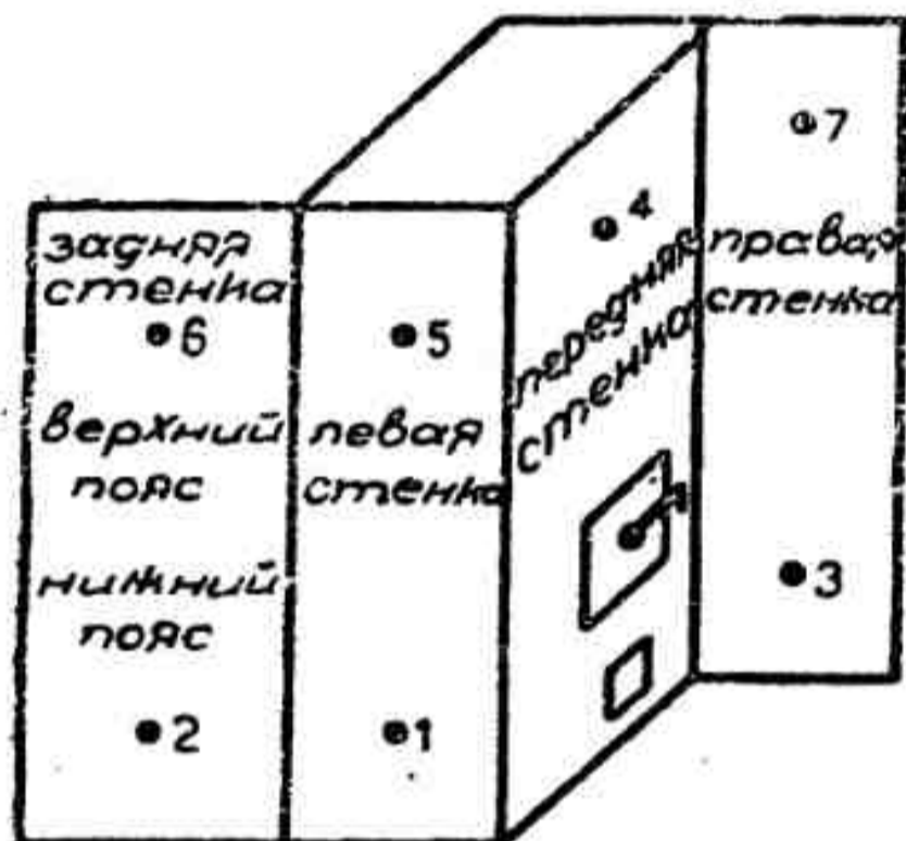
Рис. 1. Схема расположения термометров.
